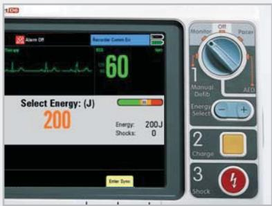
Ручная дефибрилляция: режим асинхронизированной дефибрилляции для электроимпульсной терапии при фибрилляции желудочков. Режим синхронизированной дефибрилляции для электроимпульсной терапии при фибрилляции предсердий. Широкий выбор уровней энергии до 360 Дж значительно повышает эффективность помощи различным пациентам. Индикатор контакта упложенного / присасывающегося электрода предоставляет пользователю информацию о сопротивлении перед каждым разрядным импульсом.
