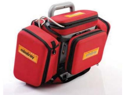
Дополнительные принадлежности для измерения ИАД, концентрации EtCO<sub>2</sub>, размещаются в верхних и задних карманах.
